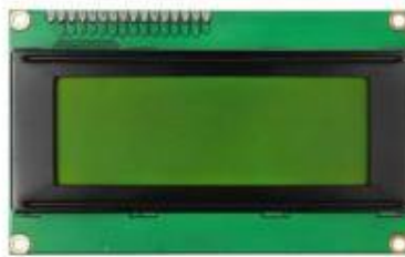
Рисунок 1.9 — Модуль екрану LCD 2004
