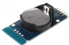
Рисунок 1.7 — Модуль Real Time Clock на DS3231SN
