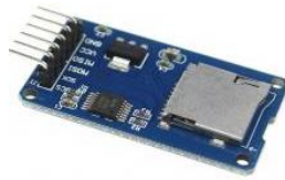
Рисунок 1.8 — Модуль microSD карти AOC431
