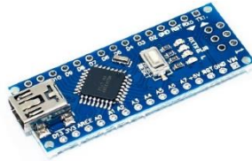
Рисунок 1.2 — Зовнішній вигляд плати Arduino Nano V3
